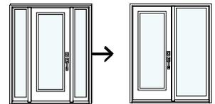
Conçu pour remplacer une configuration d'entrée avec une porte et deux latéraux de largeur 13 7/8".
